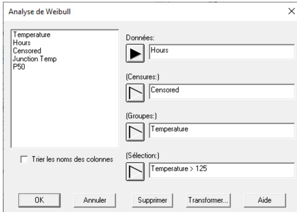
L'entrée dans le champ *Sélection*, *Temperature > 125*, est utilisée pour sélectionner les températures pour lesquelles des défaillances ont été observées, car il n'y a pas eu de défaillances à 125°C ou au-dessous.
