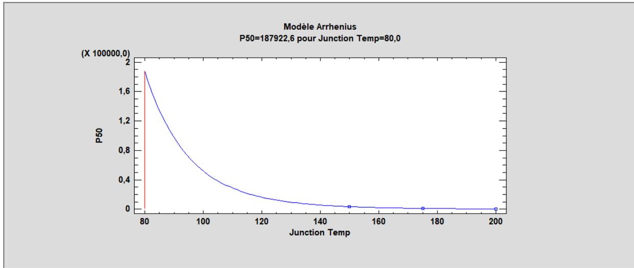
Si un modèle d'Arrhenius ajuste bien les données, les points doivent être proches de la ligne ajustée.
